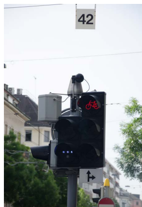
Zařízení na detekci cyklistů před křižovatkou, tzv. Traffic Eye Zürich
