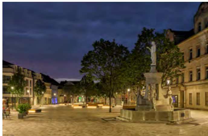
Vhodné osvětlené sdíleného prostoru nízko položenými světelnými body a světelnými prvky integrovanými do městského mobiliáře.
